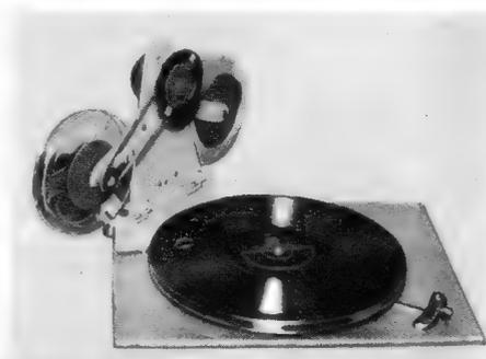
Tonbandaufsetzer zum Plattenspieler hochgeklappt
